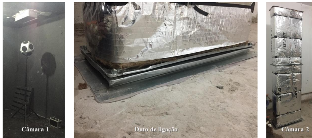
Figura 5: Câmara 1, duto de ligação e câmara 2.
