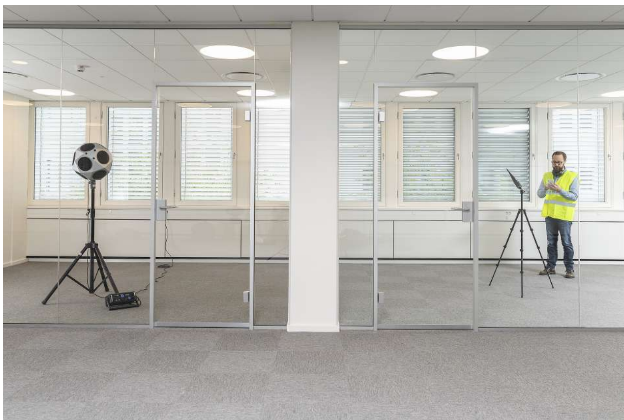
Figura 5: Ejemplo de medición: el sonómetro HBK 2255 y el amplificador HBK 2755 pueden operarse (sin cables) mediante smartphone .
