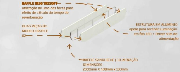
ISOMÉTRICO EXPLODIDO - BAFFLE SANDUICHE | ILUMINAÇÃO
