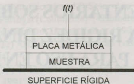
Fig. 1: esquema básico de montaje para la medición de s' .
