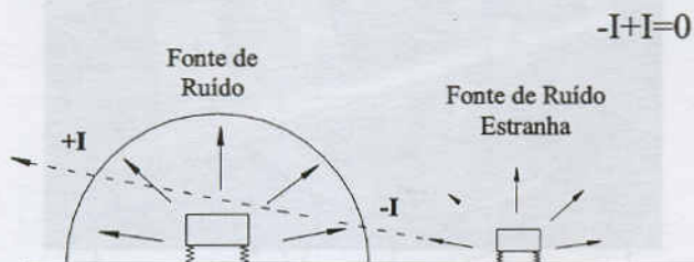
Figura 10. Efeito de fontes externa de ruído na medida de intensidade para determinação de potência sonora.
