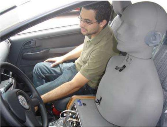
Figura 1: Exemplo de um manequim para gravação bi-auricular, durante as gravações do sistema de ventilação de um automóvel
