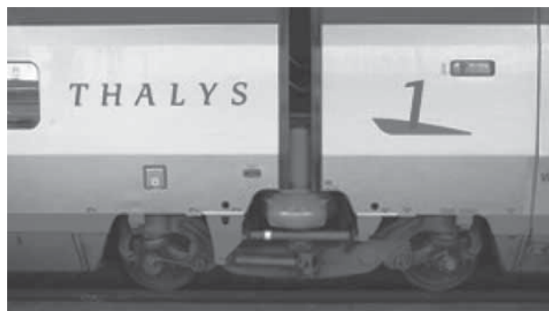
Figura 6: Truque “Jacob” em trem de alta velocidade “Thalys”
