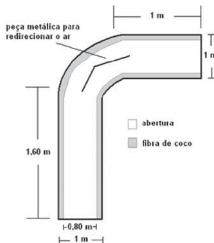
Figura 9: Seção longitudinal e dimensões do silenciador 2.
