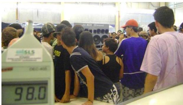
Figura 58: Medição dos NPS num automóvel que estava expondo a potência do som no evento do Dia do Trabalhador
