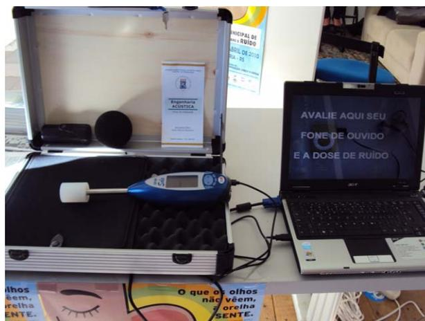
Figura 3: Sistema de medição utilizado na avaliação da exposição sonora devido ao uso de fone de ouvido.
