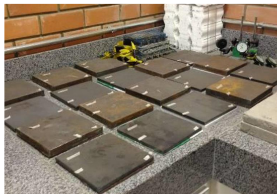
Figura 4: Ensaio de fluência à compressão com carregamentos de 4 e 8 kg aplicados nas amostras de 20x20
