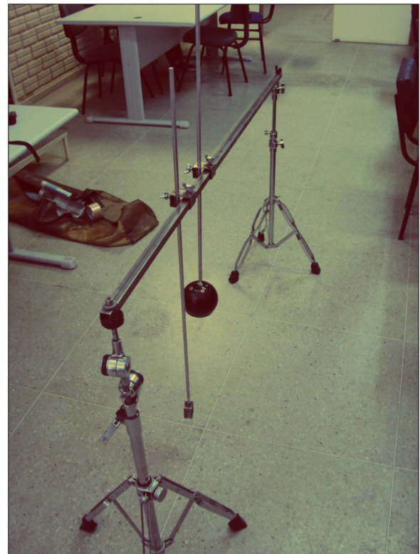
Figura 12: Foto da estrutura de sustentação da fonte sonora e microfones.
