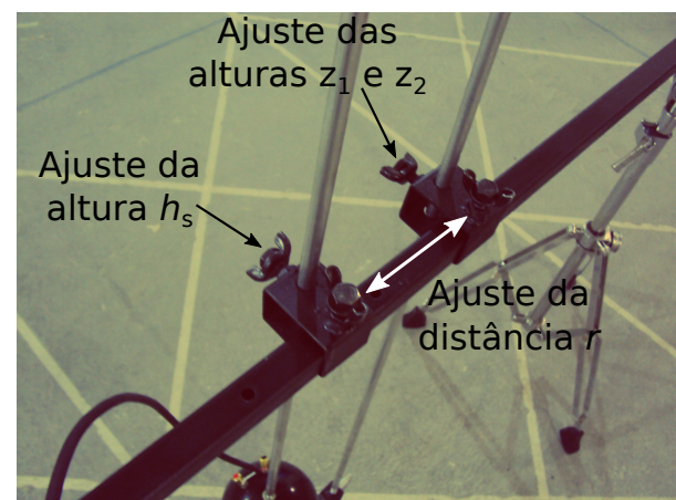
Figura 13: Detalhe dos ajustes das distâncias h_s , r , z_1 e z_2 .
