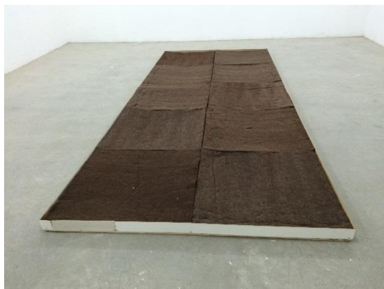
Figura 2: Montagem da amostra para os ensaios de determinação do coeficiente de absorção sonora
