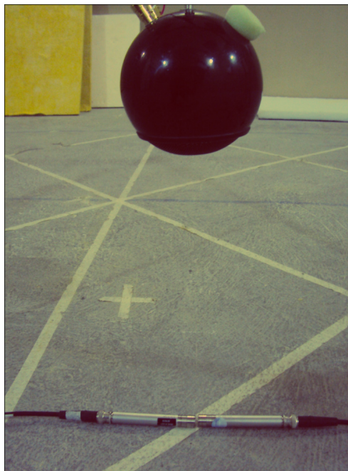
Figura 18: Foto da calibração relativa entre os microfones.
