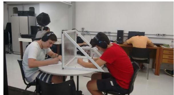
Figura 4: Execução dos testes de articulação virtuais no ambiente do LIDAV. Quatro fones de ouvido emitem simultaneamente o mesmo sinal aos ouvintes.
