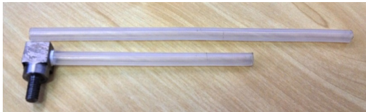
Figura 2: Corpos de prova e detalhe da peça de fixação
