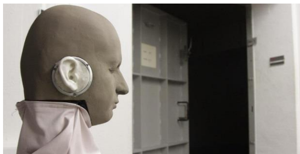
Figura 6: Cenário 8, câmara reverberante e sala contígua, com porta entreaberta. Vê-se, a cabeça artificial do manequim FABIAN (extraída de [10]).
