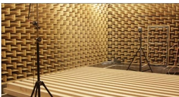
Figura 1: Cenário 1, câmara semianecoica com piso difusor (extraída de [10]).
