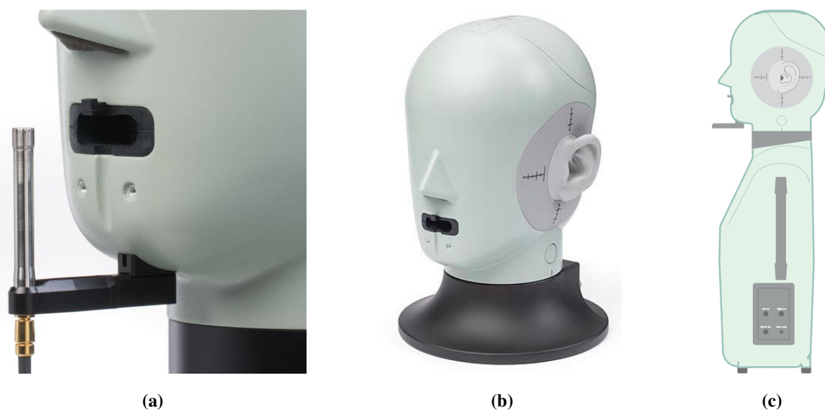
Figura 3: HATS Type 5128 (a) Detalhe da boca; (b) Tipo 5128-B e (c) Tipo 5128-C (visão lateral, ilustração).
