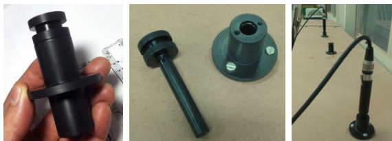
Figura 4: Fotos do suporte desenvolvido para os microfones. Esquerda: suporte não instalado, preenchido com a peça isolante; centro: suporte instalado no tubo, com a peça isolante separada; direita: microfone aplicado no tubo e suporte da posição sobressalente preenchido pela peça isolante.
