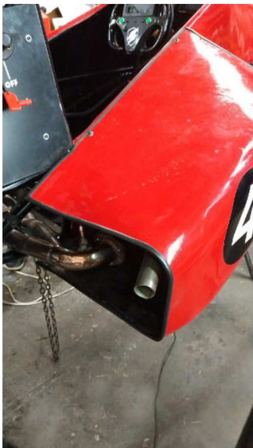
Figura 17: Conceito H instalado. Apenas a ponta do último tubo é visível com o kit aerodinâmico montado.
