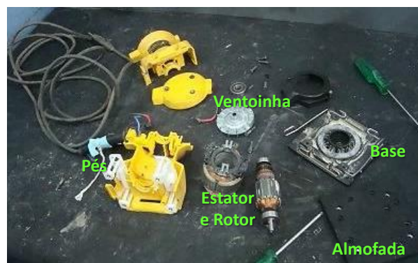
Figura 2: Principais componentes das lixadeiras orbitais elétricas.
