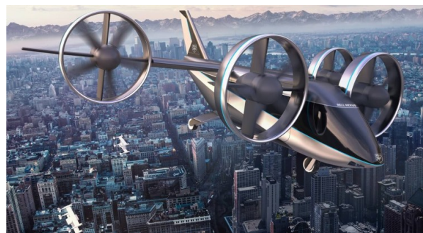
(b) Bell Nexus (configuração vectored thrust com tilt-rotor )
