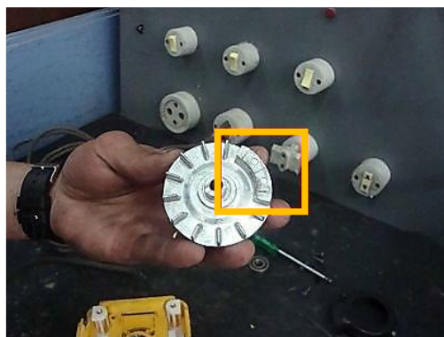
Figura 1: Ventoinha componente da lixadeira orbital. Em destaque o contrapeso.
