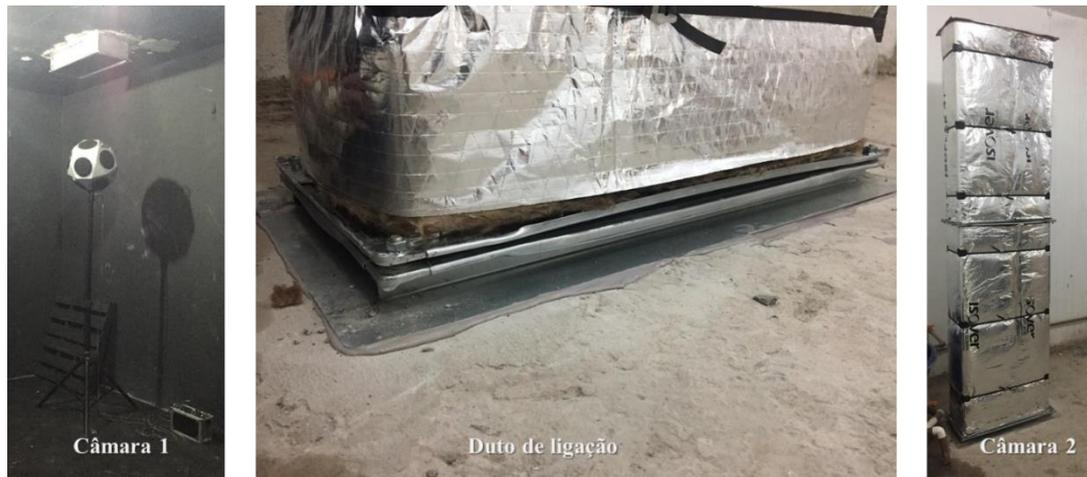
**Figura 5:** Câmara 1, duto de ligação e câmara 2.
