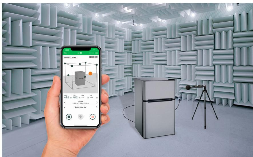
**Figura 1:** B&K 2245 oferece uma solução para medição de potência sonora que atende diversos tipos de produtos.
