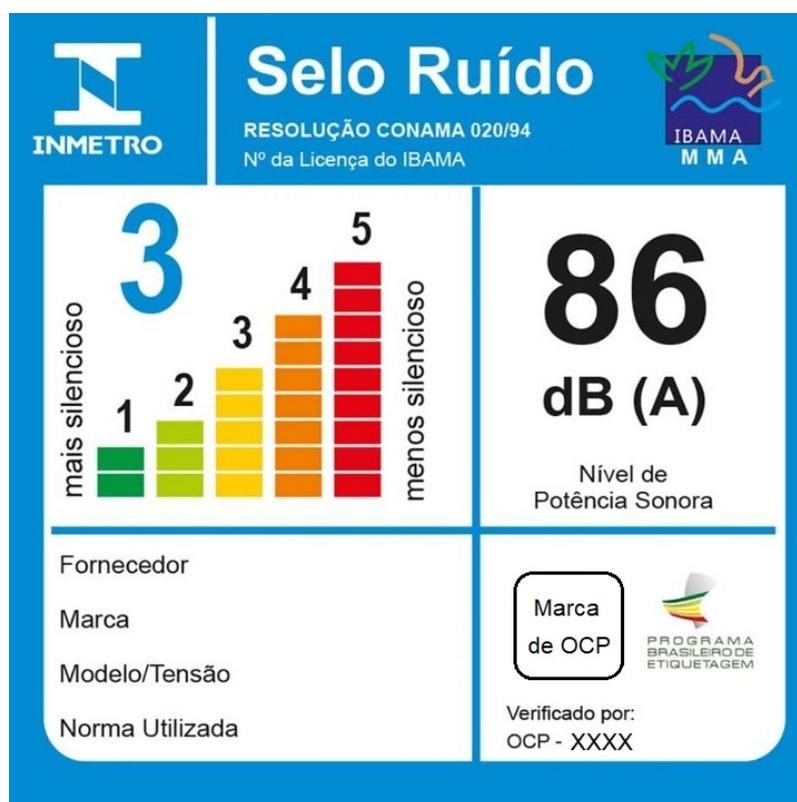
Figura 2: Modelo do selo ruído de identificação de conformidade.
