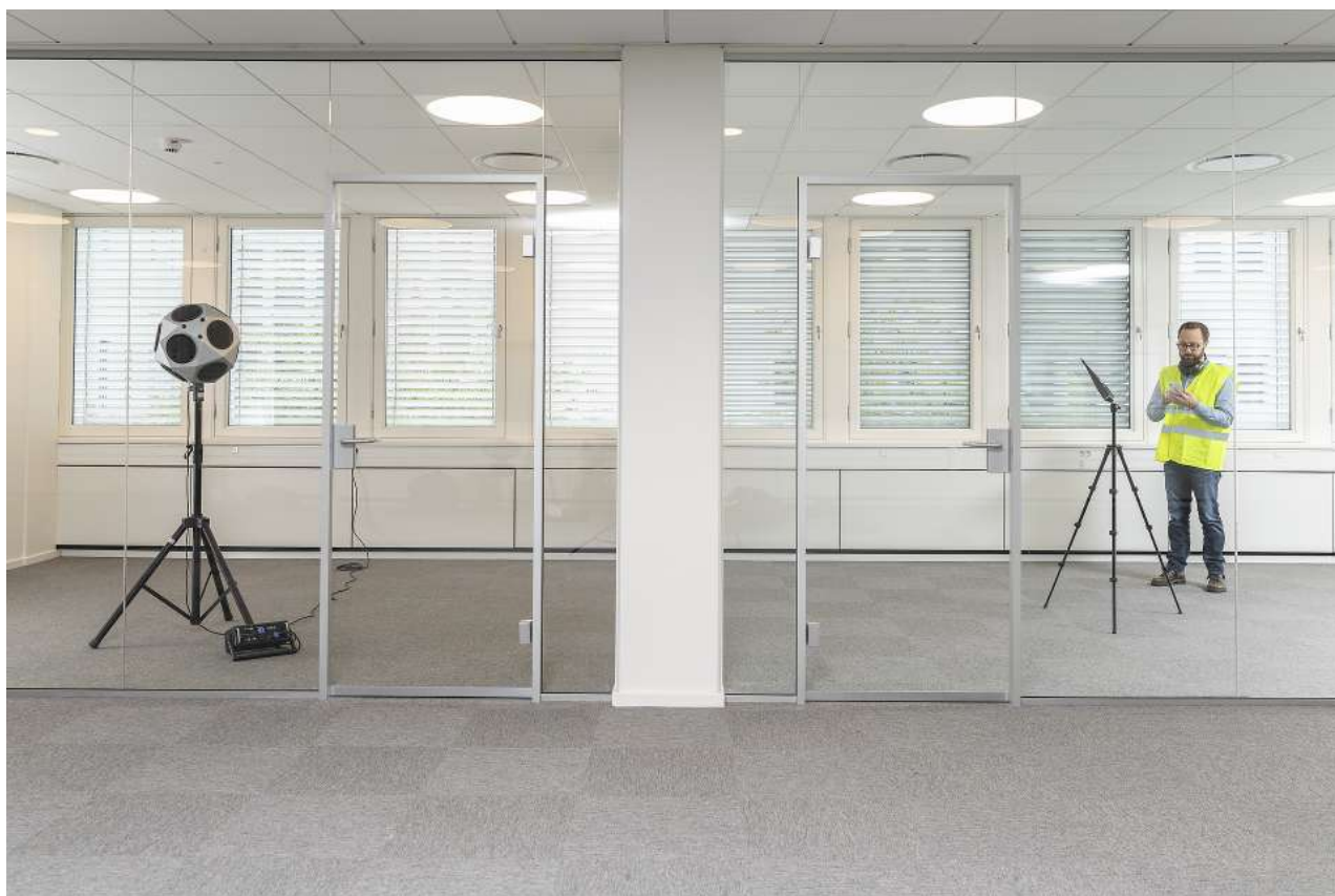
Figura 5: Exemplo de medição, o sonômetro HBK 2255 e amplificador HBK 2755 podem ser operados (sem fio) via smartphone .
